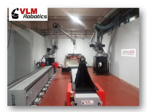
La cellule de fabrication de pièces de grandes dimensions livrée par VLM-Robotics est exemplaire dans sa conception puisque ses 18 axes sont pilotés par une commande numérique (CN) unique Sinumerik 840D. Son architecture commande numérique & multi-canal est aussi complétée par la mise en œuvre du Direct Control qui consiste à piloter les moteurs des axes directement par la CN permettant de gérer la précision et la dynamique de la machine.
