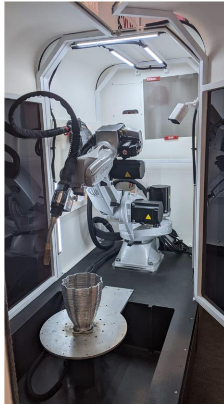
Des cellules XXL mono robot ou des cellules bi-robots 18 axes pour une pièce jusqu'à 6 m x 3 m x 1,5 m et 3 tonnes
