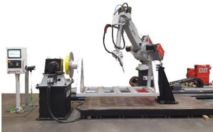
Machines XXL : SOLO mono robot ou GEMINI bi-robot pour des pièces jusqu'à 10 m X 3m et 20 tonnes
