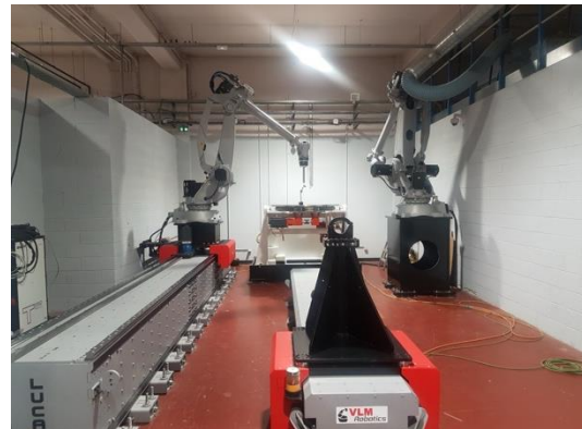
Version avec un axe linéaire robot et un axe linéaire pièce
